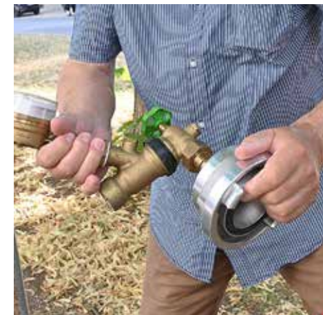
Mit einem Spezialschlüssel, einem Druckminderer und einem Wasserzähler kann Mathias Schmidt den Schlauch an den Hydranten anschließen.
